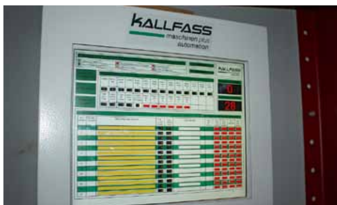
Die Kallfass-Steuerung zeigt auf einen Blick die Füllstände der Boxen, auch die Dimensionen können abgerufen werden
