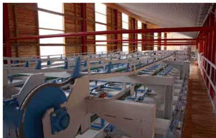
Auf engstem Raum eingepasst: Bis zu 6,1 m langes Schnittholz sortiert Züfle mit seiner Kallfass-Anlage
