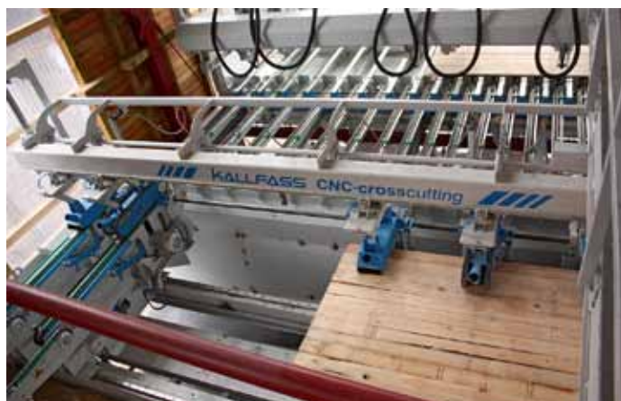
Die erste Lage Schnittholz passiert die CNC-Crosscutting-Maschine und geht weiter zur Stapelbildung
